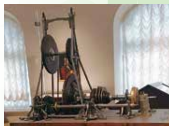
Станок токарно-копиральный медальерный и гильошинный работы А. К. Нартова
